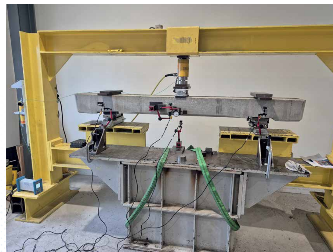
Banc d'essai des traverses en béton bas carbone Sateba
